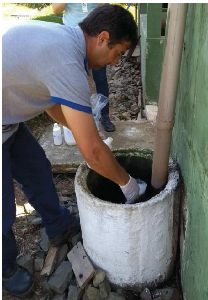
Figura 33: Coleta de Efluente – Saída Físico-Químico – fevereiro de 2018.
