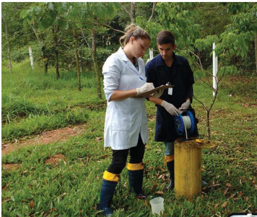
Figura 15: Poço piezométrico, outubro de 2017.
