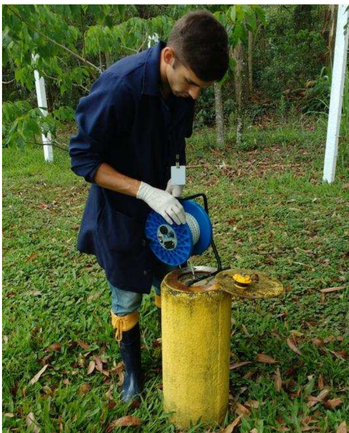
Figura 13: Poço piezométrico, novembro de 2016.
