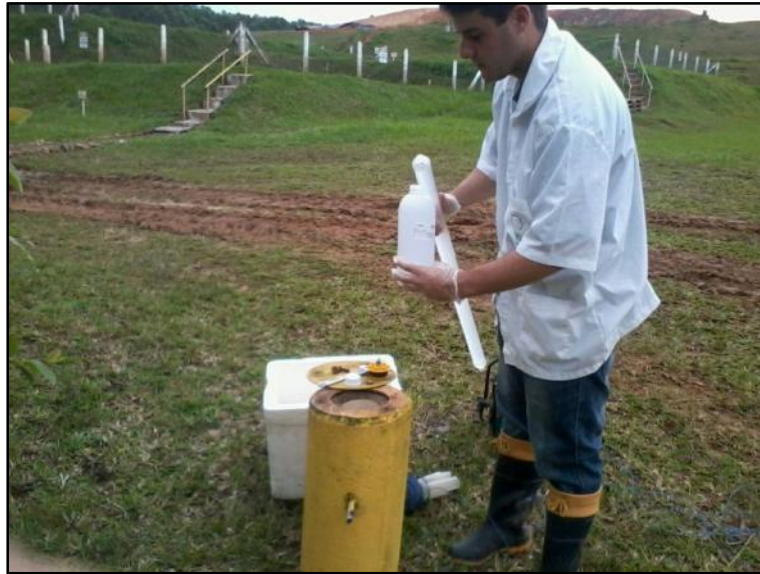
Figura 18: Coleta de amostras de águas subterrâneas, fevereiro 2016.
