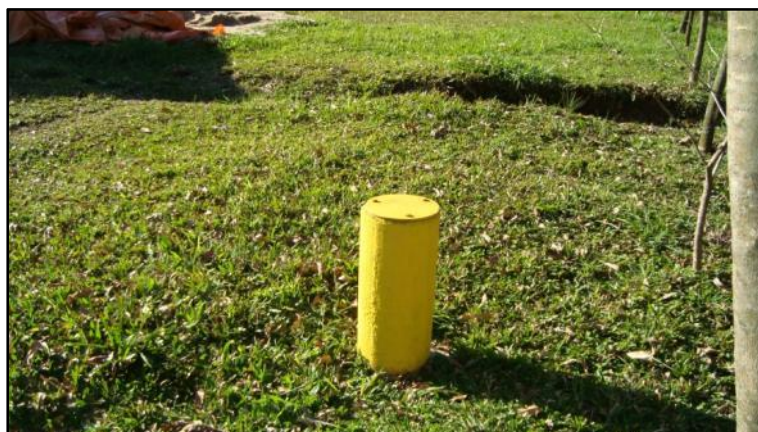
Figura 17 : Poço piezométrico, março de 2016.
