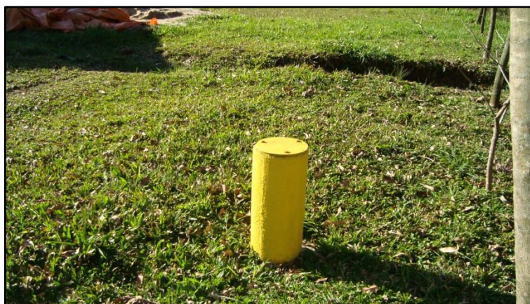
Figura 24: Poço piezométrico, agosto de 2015.
