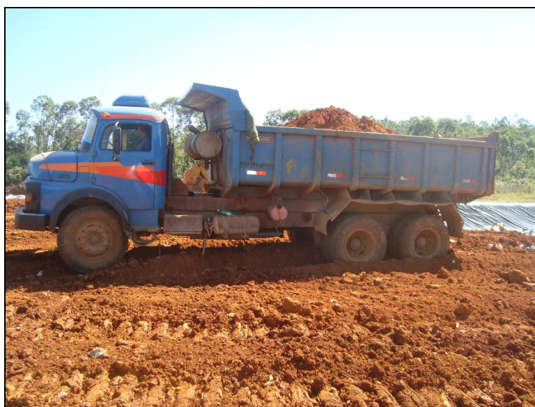
Foto 3: Caminhão truck carregado com argila para cobertura do resíduo, março 2010.
