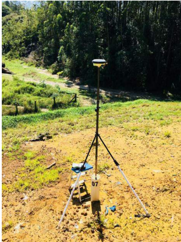
Figura 3: Detalhe de marco superficial sendo monitorado.
