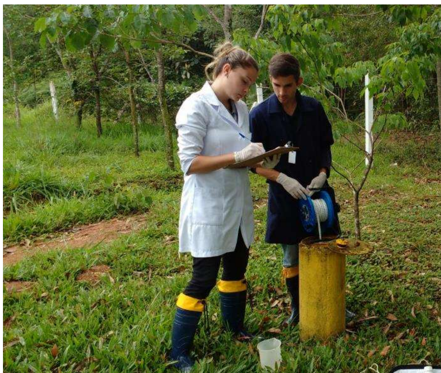
Figura 103: Poço piezométrico, outubro de 2017.
