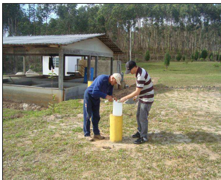
Figura 18: Coleta do piezômetro 3 jusante, outubro 2010.
