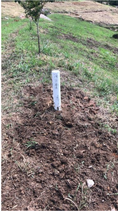
Figura 23 Instalação de novos marcos de monitoramento geotécnico.
