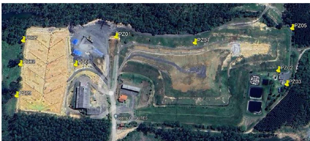
Figura 16 – Localização dos poços piezométricos no aterro do Cirsures.
