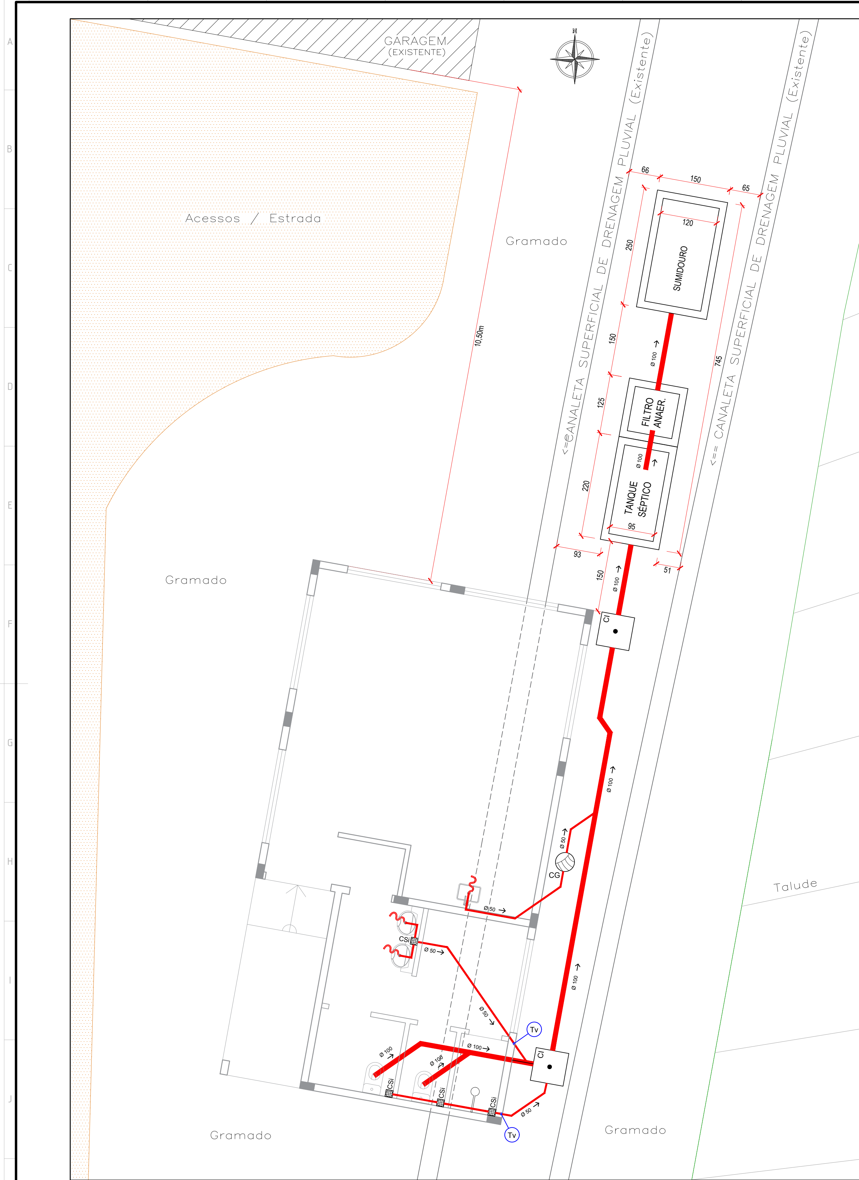
PLANTA BAIXA - SISTEMA SANITÁRIO Nova Edificação do Refeitório Escala ..... 1 : 50
